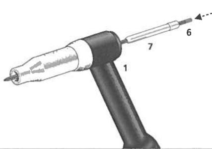
Wolframelektrode [6] und Spannhül-se [7] von hinten in den Brenner-körper [1] stecken
