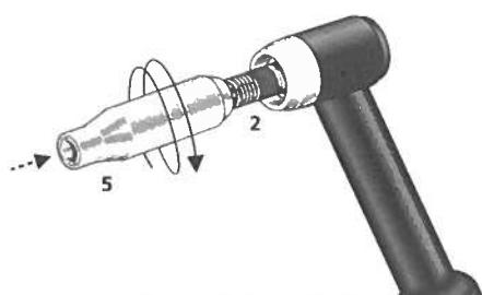
Gasdüse [5] auf Spannhülsenge-häuse/Gaslinsen [2] aufschrauben
