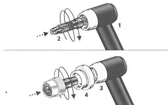
Spannhülsen-gehäuse [2] in den Brennerkörper [1] einschrauben
